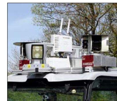
Abb. 4: Sensorik für teilautonomes Fahren (Laserscanner)
