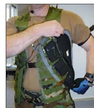
Abb. 3: HealthLab in einer zur persönlichen Ausrüstung des Soldaten gehörenden Weste. Aufnahmegeräte und Umweltsensorik in der Weste, physiologische Sensorik am Körper unter der Kleidung und an der linken Hand
