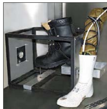
Abb. 1: Thermophysiologicals Prüfsystem CYBOR (Cybernetic Body Regulation) zur Simulation von mikroklimatischen Zustandsverläufen (T/r. F.) in Fußbekleidungssystemen
