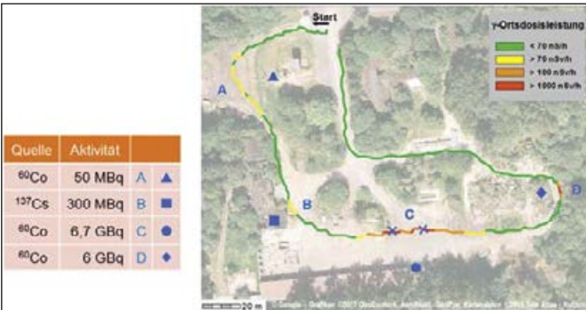
Abb. 4: Messwerte Gammadosisleistung als farbkodierter Fahrweg in einem Satellitenbild dargestellt. Es sind bei einer Suchfahrt vier Gammaquellen an den Positionen A bis D gefunden worden. Die Symbole markieren die Quellorte
