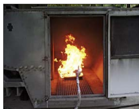
Abb. 2: Brandversuch im Modell des Innenraums eines GTK BOXER
