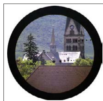
Abb. 3: Blick durch ein Zielfernrohr mit Filterschäden
