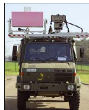
Abb. 3: Installation des SUM-Systemdemonstrators auf einem militärischen Fahrzeug
