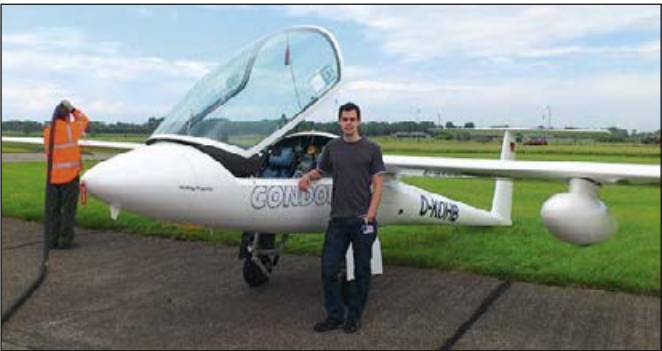
Abb. 1: Wing-Pod mit Hyperspektralsensor an Motorsegler der OHB System AG
