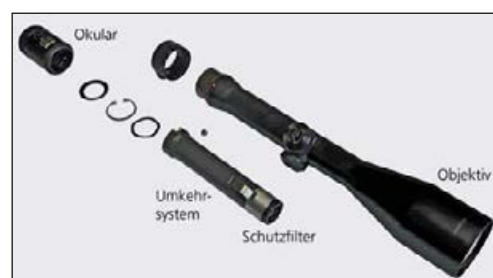
Abb. 2: Zerlegtes Zielfernrohr mit Schutzfilter
