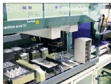
Abb. 2: Pipettier- und Inkubierplattform für Radioliganden-Bindungsassays im Hochdurchsatzverfahren
