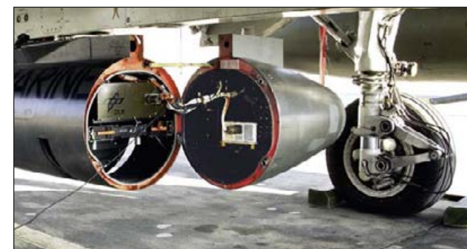
Abb. 3: Seitenansicht des Kamerasystems im geöffneten Pod
