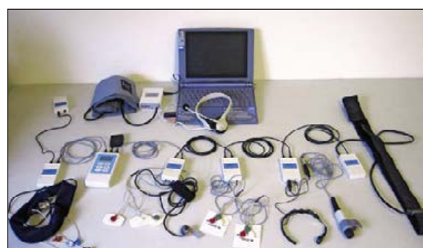
Abb. 1: HealthLab bestehend aus einem Master und mehreren Satelliten, die kombiniert werden. Multiple Messmöglichkeiten von physiologischen Parametern, einfache Bedienbarkeit mittels Laptop, Tablet oder Smartphone
