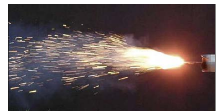
Abb. 4: Angeströmter Abbrand eines Scheinziels im Realmaßstab
