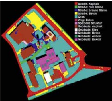
Abb. 4: Automatische Klassifizierung von Objektklassen aus Hyperspektraldaten (VIS-NIR)
