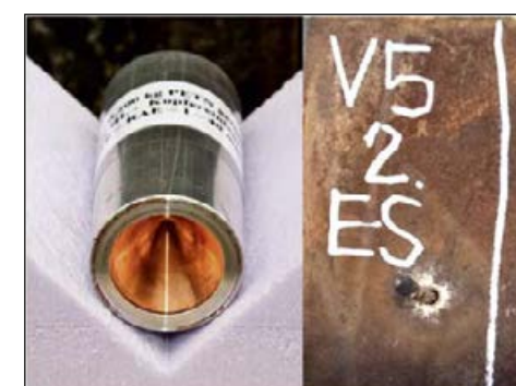
Abb. 5: Hohlladung mit UFG-Kupfer als Linermaterial (links) und getestete Panzerplatte (rechts)
