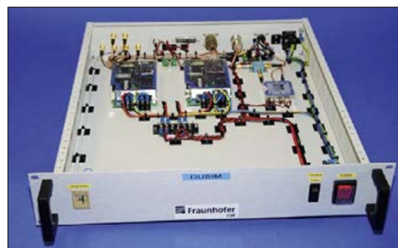
Abb. 2: Kontrolleinheit und Spannungsversorgung für das DUSIM Radar-Frontend
