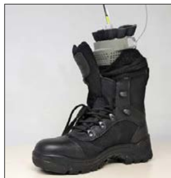
Abb. 2: Prüfsystem SWEATOR, eingesetzt in einen Stiefel, zur Messung und Bilanzierung der trockenen und feuchten Wärme-flüsse bei Fußbekleidungssystemen
