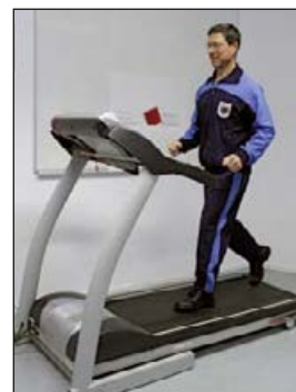
Abb. 3: Trageversuche mit Probanden auf einem Laufband-Ergometer zur Aufnahme von objektiven und subjektiven Tragekomfort- sowie Empfindungsdaten bezogen auf den Fußbereich
