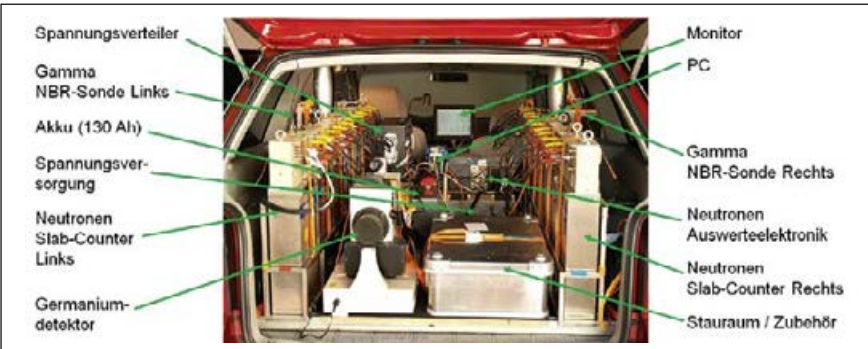
Abb. 1: Messsystem im Fahrzeug eingerüstet
