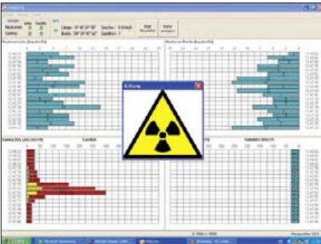
Abb. 3: Screenshot der Monitoranzeige mit einem Gammaquellenfund auf der linken Fahrzeugseite
