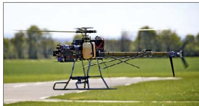
Abb. 2: Ein Hubschrauber-UAV dient als Versuchsträger zur Erprobung verschiedener Missions- und Flugführungssysteme. Eine modulare Nutzlastplattform ermöglicht die Verwendung variabler Rechner- und Sensorkonzepte
