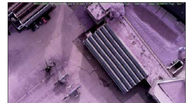
Abb. 4: Sensordaten werden während der Flugversuche live zur Bodenkontrollstation übertragen und dort mit Fluglagedaten des UAV überlagert dargestellt, um die Situation Awareness des Operators zu erhöhen. Die Qualität des Videostreams wird dynamisch an die aktuelle Bandbreite der Funkverbindung angepasst
