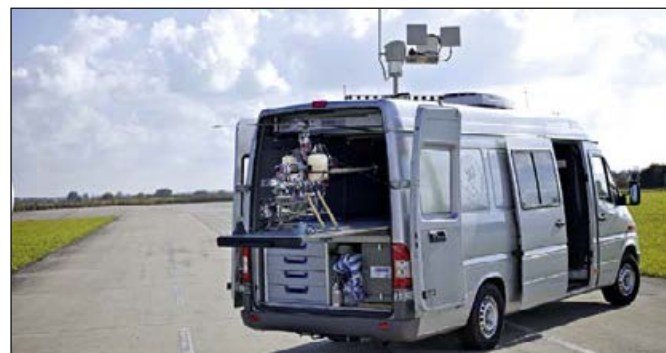
Abb. 1: Die mobile Bodenkontrollstation beherbergt den Operator-Arbeitsplatz bei Flugversuchen. Sie umfasst die Operator-Konsole, eine eigene Stromversorgung, sowie Rechnerplattformen für Assistenzfunktionen. Ein Kamera-Verfolger auf dem Dach der Bodenkontrollstation erweitert den Radius der Funkverbindung über die Nachführung von Richtantennen
