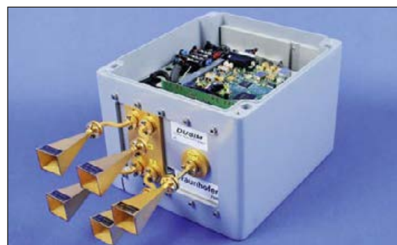
Abb. 1: DUSIM – Vierkanaliges Radar-Frontend mit einer Ausgangsleistung von 100 mW bei 94 GHz
