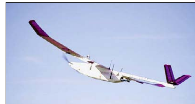
Abb. 3: Das Elektrosegler-UAV des Instituts für Flugsysteme der Universität der Bundeswehr München dient zur Demonstration und Erprobung von kognitiven Softwareagenten zur Missionsführung
